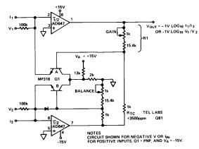
Figure 25. Log-Ratio Amplifier
