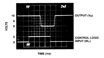
$SSM\ 2412\ T_{ON}/T_{OFF}\ Switching\ Response$
